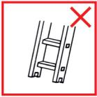
**3.3** Les barres stabilisatrices doivent être fixées par l'utilisateur avant l'utilisation.
