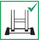
4.5 Si une échelle est livrée avec des barres stabilisatrices et que ces barres doivent être fixées par l'utilisateur avant la première utilisation, cela doit être précisé sur l'échelle et dans le mode d'emploi.
