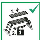
**8.1** Si l'échelle est utilisée comme plate-forme, seuls les revêtements recommandés par le fabricant de l'échelle doivent être utilisés. Le revêtement doit être fixé avant l'utilisation (uniquement si cela est nécessaire, en fonction de la conception de l'échelle).
