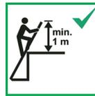
4.11 Les échelles utilisées pour accéder à un niveau supérieur doivent être étendues à au moins 1 m au-dessus de l'extrémité de l'échelle hors extension et doivent être sécurisées si cela est nécessaire.
