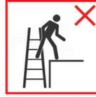
**3.15** Ne descendez pas par le côté d'une échelle transformable sur une autre surface.
