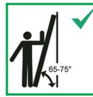
4.10 Les échelles simples à barreaux doivent être utilisées avec l'angle d'inclinaison adéquat.
