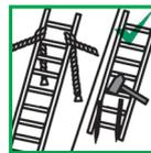
4.12 Une échelle simple doit être appuyée contre une surface plane et dure, et être sécurisée avant d'être utilisée, par exemple en la fixant ou en utilisant un dispositif approprié pour assurer sa stabilité.
