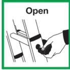
**6.2** Pour déverrouiller l'échelle, rétractez les verrous.
