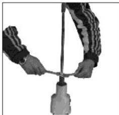
Vissez la pale sur la machine. Utilisez une clé plate fournie pour serrer la pale et l'autre clé plate fournie pour contre-serrer la broche sur le méplat prévu à cet effet.
