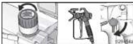
4. Maintenez fermement une partie métallique du pistolet contre les parois d'un seau métallique relié à la terre. Actionnez le pistolet pour relâcher la pression.
