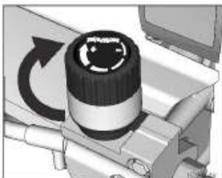
6. Mettez la vanne d'amorçage en position horizontale. Déverrouillez la gâchette.
