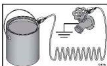
Pour maintenir la continuité de la mise à la terre lors du rinçage du pulvérisateur ou de la décompression : maintenez fermement la partie métallique du pistolet pulvérisateur contre le côté d'un seau métallique relié à la terre, puis actionnez le pistolet.
