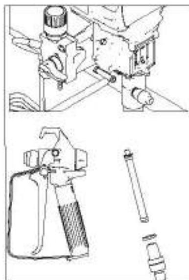
14. En cas de rinçage à l'eau, rincez à nouveau avec du white-spirit ou du fluidifiant pour pompe afin que ce produit forme un revêtement de protection qui empêchera le gel ou la corrosion.
