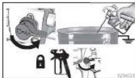
12. Toumez le bouton de commande de pression sur la pression minimale et mettez l'interrupteur MARCHE/ARRÊT sur la position ARRÊT. Débranchez l'alimentation électrique du pulvérisateur.
